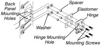
FIGURE 3 - ADJUSTING THE HINGE (DUALFLEX ONLY) - CONVERTING HINGES
